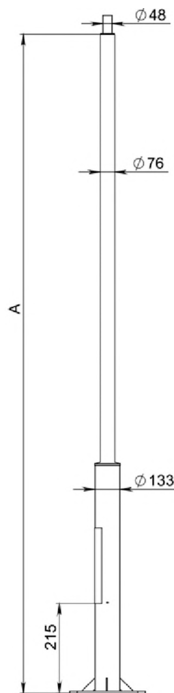
Опора металлическая трубчатая фланцевая серии МНД-Ф-Х-02-Х
